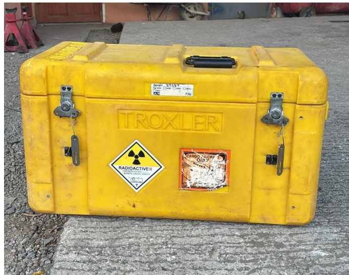
Figura 2. Cotenedor que alberga el Medidor de densidad y humedad que contiene fuentes radiactivas similar al equipo sustraído
