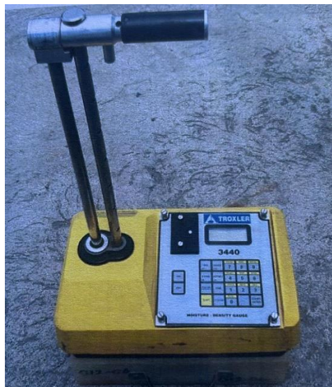
Figura 1. Medidor de densidad y humedad que contiene fuentes radiactivas similar al equipo sustraído
