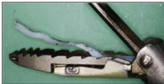
Figura 2. Ejemplo de desprendimiento del protector PTFE
